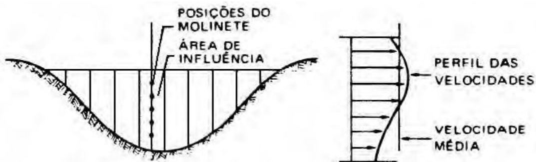
Figura 1. Traçado do perfil da seção transversal para medição da vazão com molinete.
