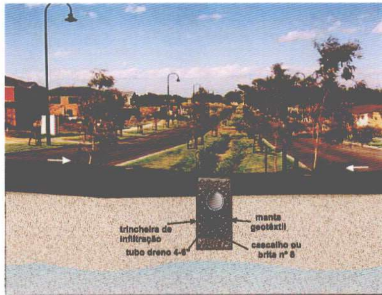
FIGURA 15- 5: TRINCHEIRA DE INFILTRAÇÃO EM CANTEIRO CENTRAL – WSUD
